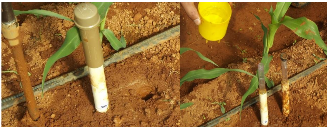
Figura 4. Instalação dos tensiômetros em diferentes profundidades para a realização do manejo da irrigação. Fonte: ARAÚJO, A. L. G. (2015).
